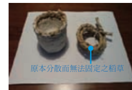
將強塑材 S1 塗抹於稻草之上，可藉由強塑材 S1 彼此黏著而達到防水之效果。
