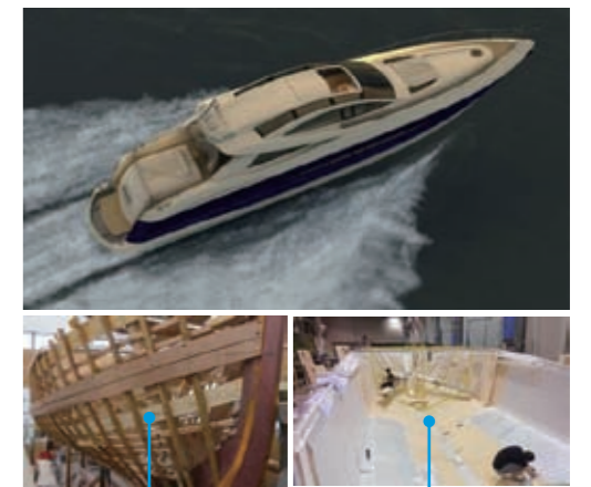
木殼遊艇骨架 建築遊艇複合材料可取代傳統防水布
